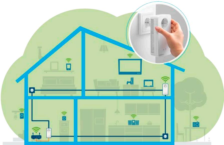
> Der erste Powerline-Adapter steckt in einer Wandsteckdose beim Router (unten links) und verbindet sich über die Stromverkabelung mit dem zweiten Adapter. (Foto: Devolo.de)
